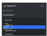
Über "Einstellungen" -> "MQTT" erreicht man die Konfigurationsseite der Datenanbindung. Die Parameter sind analog der Screenshots unten einzustellen. Details s. Erläuterungen weiter unten.
