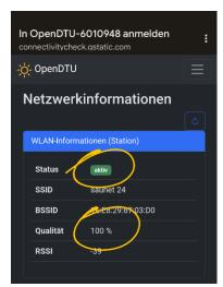
Nach erfolgreicher Konfiguration sollte das aussehen wie links dargestellt. Im Block "WLAN-Informationen (Station)" ist der Status "aktiv". Das Feld "Qualität" gibt Auskunft über die Empfangsstärke des WLAN-Signals. Sollte die Verbindung nicht geklappt haben, liegt das in aller Regel an fehlerhaften Zugangsdaten, dann bitte korrigieren und neu versuchen (Zurück zu Schritt "Netzwerkeinstellungen aufrufen").
