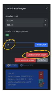
Um einen 800 W Wechselrichter auf 600 W zu limitieren, setzt man das Limit ("Relativ (%)") auf 75. Durch den Knopf "Limit dauerhaft setzen" wird das nichtflüchtig gespeichert, auch nach einem Neustart des Wechselrichters bleibt die Limitierung erhalten.
