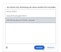
Hier das entsprechende "USB JTAG/serial"-Device auswählen. Sollten mehrere in der Liste erscheinen, kann man durch das Einund Ausstecken der OpenDTU das Richtige identifizieren.
