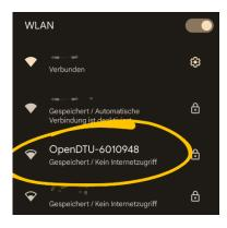
Die OpenDTU öffnet jetzt ein eigenes WLAN-Netz namens "OpenDTU-xxxxxxx". Mit dem Mobiltelefon oder Laptop eine Verbindung dazu herstellen. Das Standard-Passwort ist "openDTU42".
