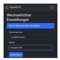
Oben auf dem Fomular kann ein neuer Wechselrichter hinzugefügt werden. Dazu einfach die vollständige Seriennummer eingeben und optional einen Namen für den Wechselrichter. Über den Knopf "Hinzufügen" wird der Wechselrichter gespeichert. Bei Bedarf können hier auch mehrere Wechselrichter nacheinander angelegt werden.
